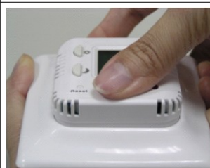
Docisnąć panel przedni aż do zatrzaśnięcia
