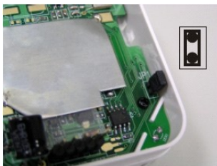
Czujnik temperatury pomieszczenia włączony (założona zwora)
